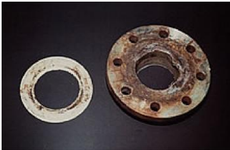
Figure I.8: Corrosion caverneuse d'un acier allié sous un joint [35].
