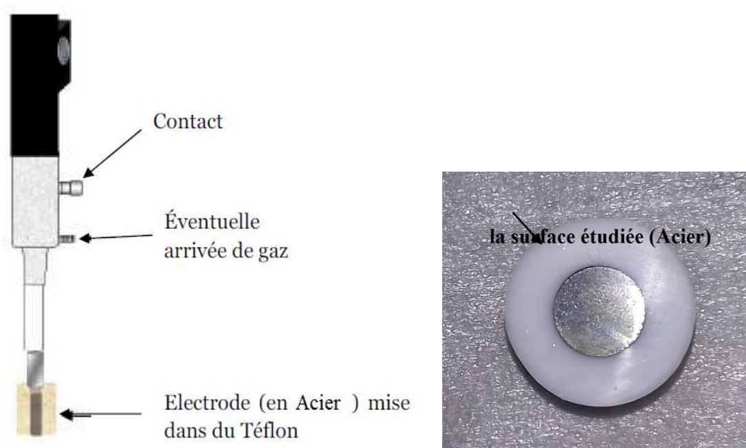
Figure II. 2. : Schéma de l'électrode à disque (EDT) [2].
