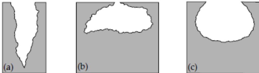
Figure I.6 : Formes de piqûres (a) cavité profonde (b) cavité cavernue (c) hémisphérique [34].
