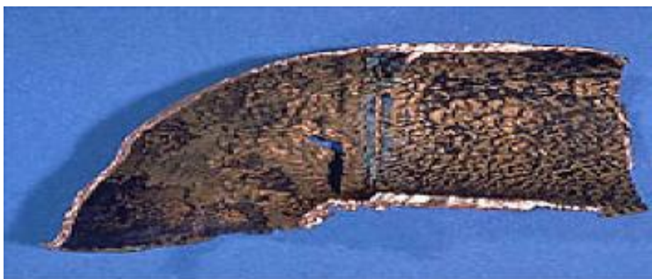
Figure I.9: Corrosion érosion d'un tube en cuivre véhiculant de l'eau [35].
