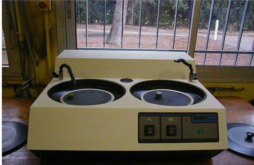
**Figure II.4 :** *La polisseuse mécanique utilisée.*
