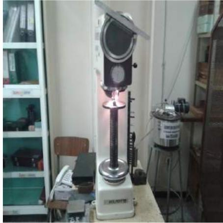
**Figure II.5 :** Machine d'essais de dureté.
