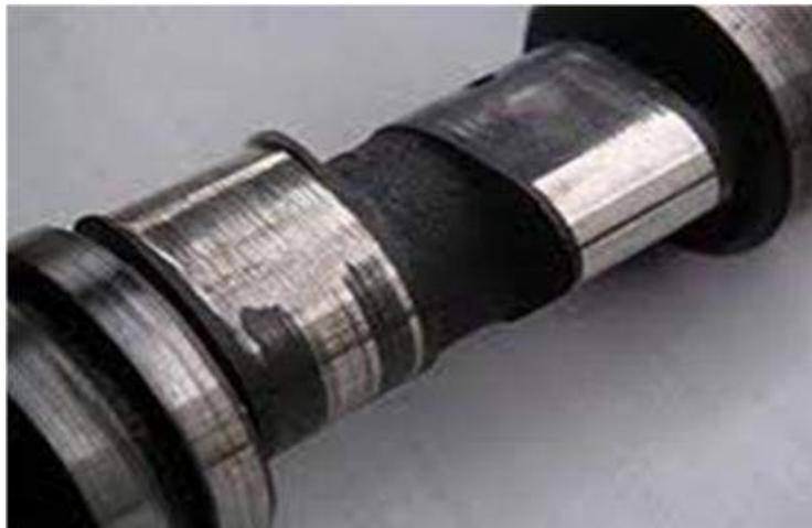
**Figure I.15 :** *usure par fatigue* [29].
