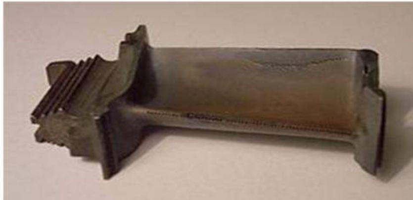
**Figure I.17 :** *usure par érosion* [29].
