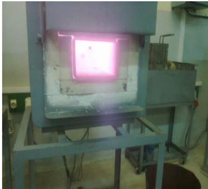
**Figure II.3 :** Four électrique à chambre horizontale.
