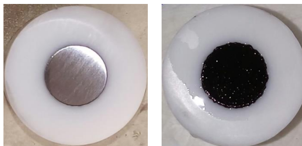
Figure III.5. Photos avant et après dépôt de film de Ppy sur l'acier dans la solution C_2H_2O_4 (0.25M). Temps de synthèse = 60 min. C_{py} = 0.1M . i_{imposée} = 1.5 mA/cm^2 .
