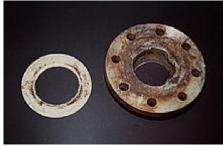
Figure I.5. Corrosion cavernuse d'un acier allié sous un joint.
