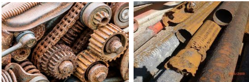
Figure I.1. Exemples de matériaux soumis aux phénomènes de corrosion.
