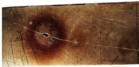
Figure I.6. Corrosion par piqûres.
