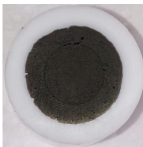
Figure III.8. Photo du film Ppy dopé par les ions molybdate (0.05M) obtenu sur l'acier dans la solution C_2H_2O_4 (0.25M) et i = 1.5 \text{ mA/cm}^2 . Temps de synthèse = 60 min. C_{py} = 0.1M .
