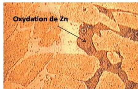
Figure I.8. Corrosion sélective d'un laiton (alliage cuivre-zinc).
