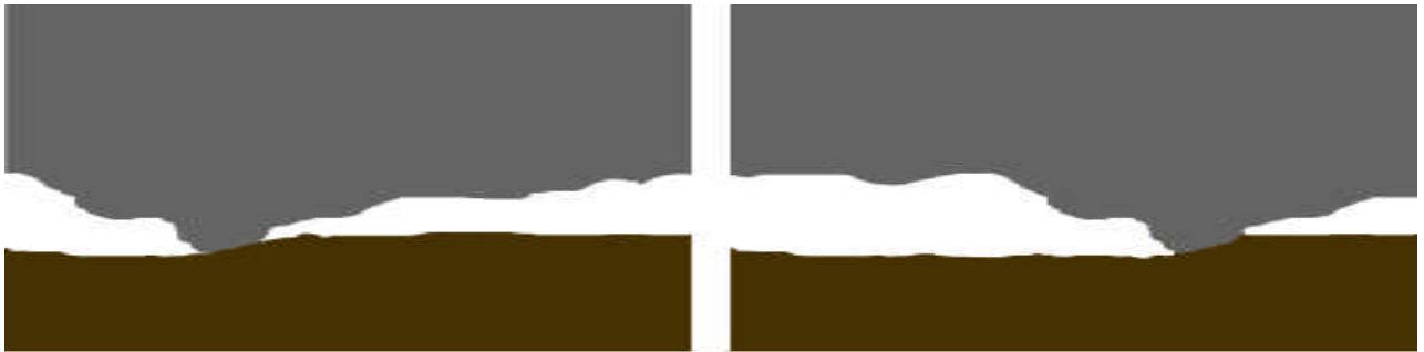
Figure.I.5: Mécanisme d'usure abrasive.
