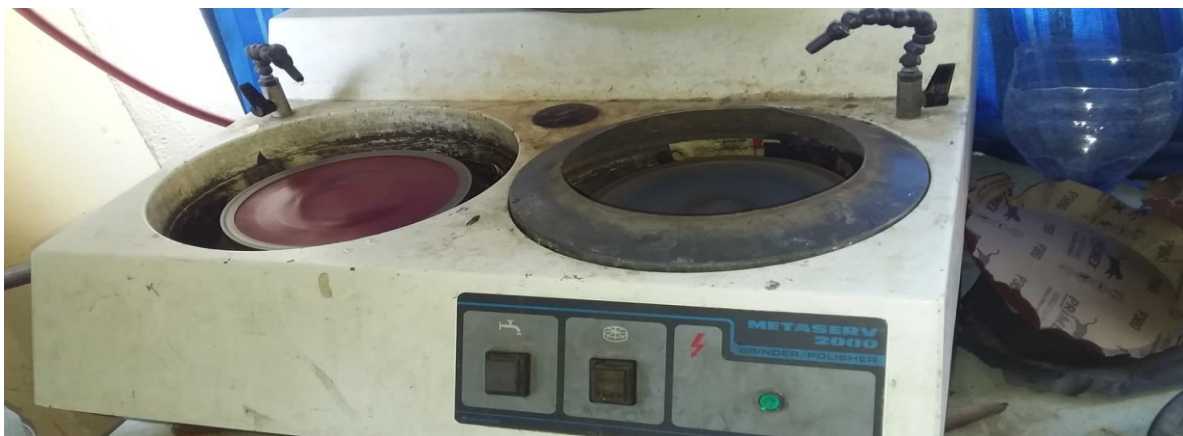
Figure II.14: Polisseuse mécanique de marque (METASERV 2000).
