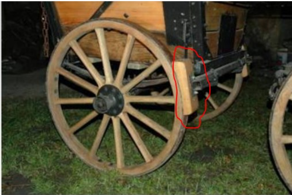
Figure.I.13: Sabot vient frotter sur la roue.
