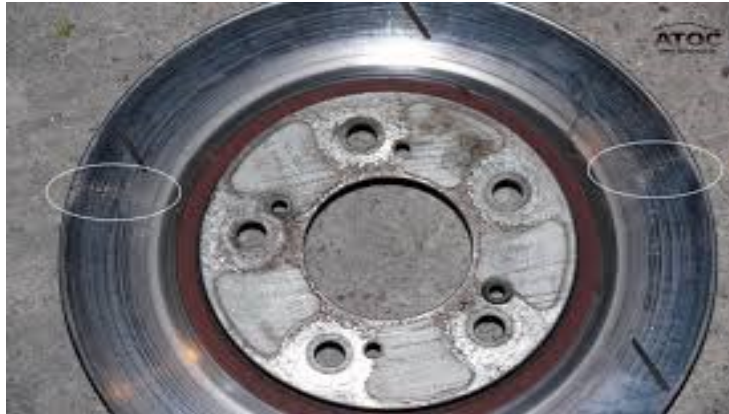
Figure.I.32: Un disque usé.
