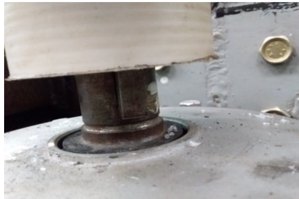
Figure II.4: Montage de clavette sur arbre de moteur.
