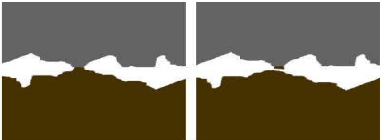
Figure.I.6: mécanisme usure adhésive [9].
