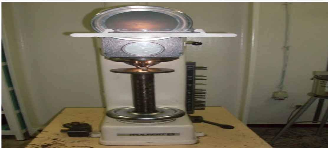
Figure II.15: Machine de dureté universelle Brinell, Vickers et Rockwell de l'UGB.
