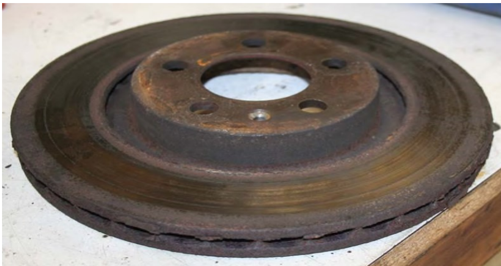
Figure.I.33: Disque de frein rouillé.
