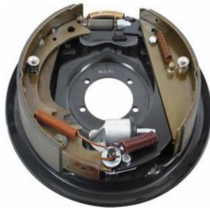
Figure.I.14: Illustration d'un frein à tambour.
