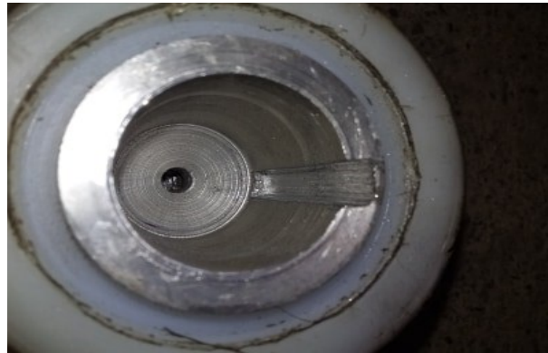
Figure II.3: réalisation d'une rainure de clavette.
