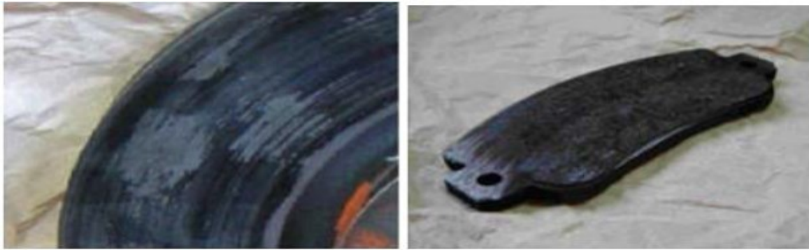
a) Dépôts de matière sur les pistes du disque b) Usure excessive d'une plaquette de frein
