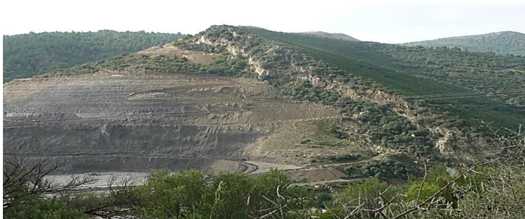
Fig. II.5 : Vue du gisement du Nord vers le Sud montrant l'ensemble tuf reposant sur l'argile, sous forme de monoclin d'inclinaison générale vers le Nord-Ouest.
