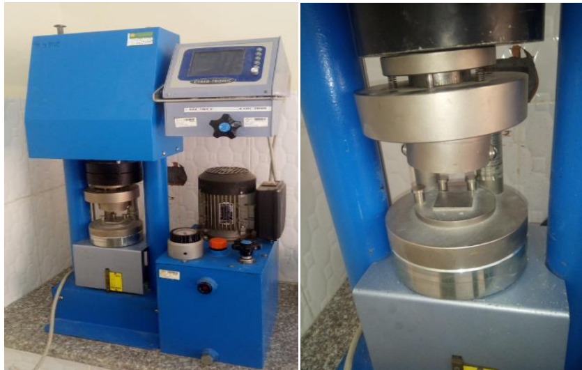
Fig. II.23: Presse de compression à béton avec mécanisme spécial pour échantillons cubiques 40x40x40 mm 3 .
