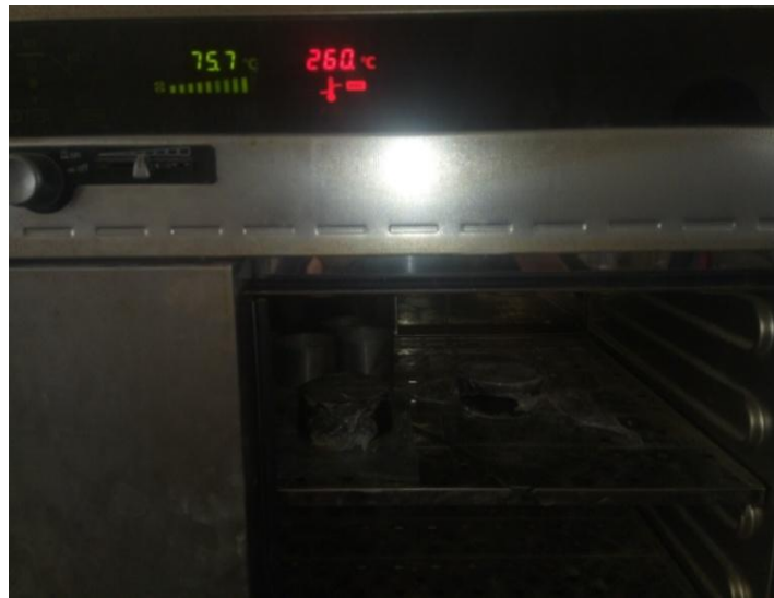
Fig. II.17 : essai de prise sous température.
