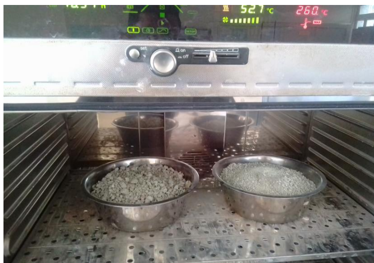
Fig II.10 : séchage de la pouzzolane concassée.
