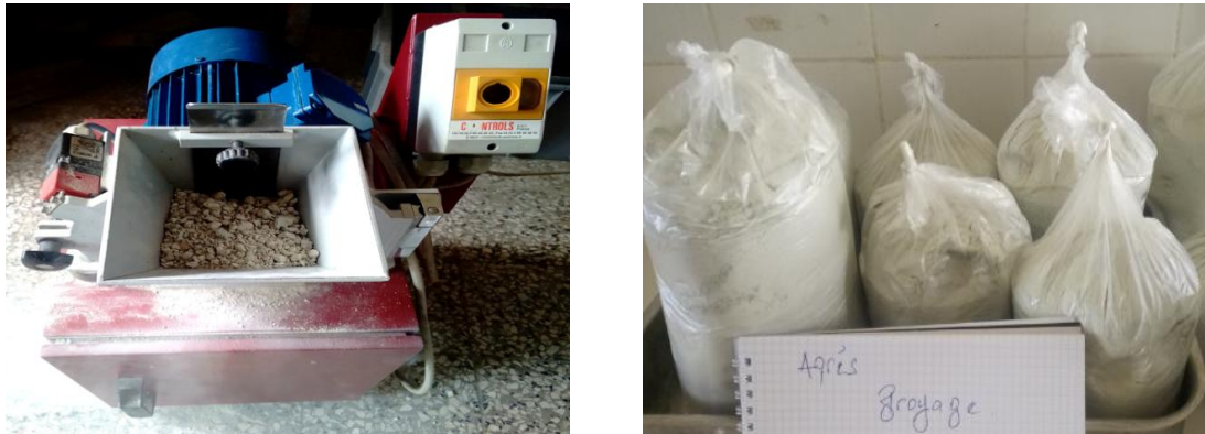
Fig II.11 : broyeur utilisé et matériau obtenu après broyage.
