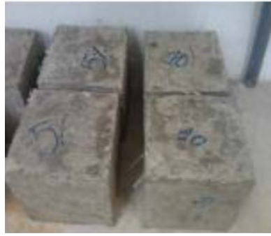
Figure II.4. Echantillons de composite fibres-matrice à base de ciment [23].
