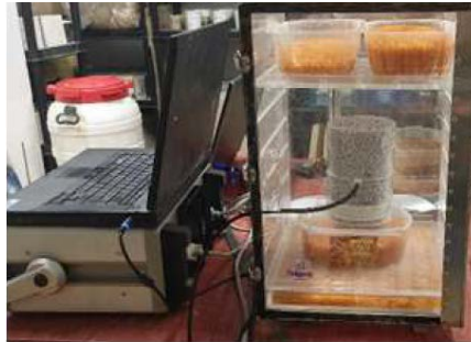
Figure II.19. Mesure de la conductivité des charges à l'aide d'un CT mètre [70].
