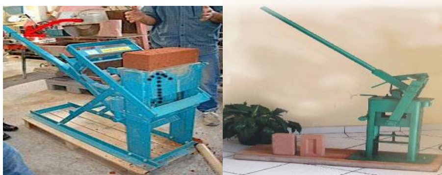
Figure I.13 Brique de terre crue compressée réalisée à l'aide d'une presse manuelle [37]
