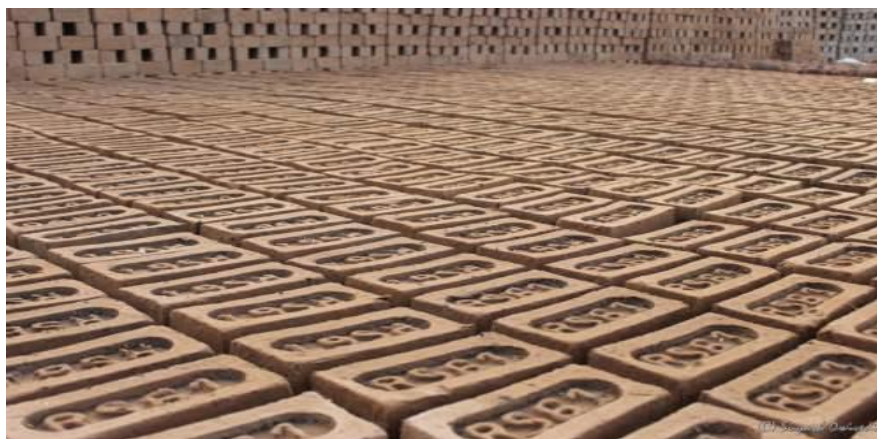
Figure I.30 Briques crues (vertes) [56]
