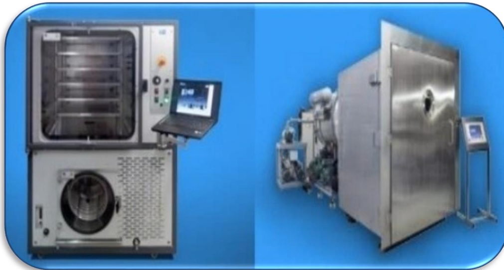
Figure 8. Lyophilisateur pilote LPCCPLS15 et lyophilisateur de production (Cryotec, 2015)
