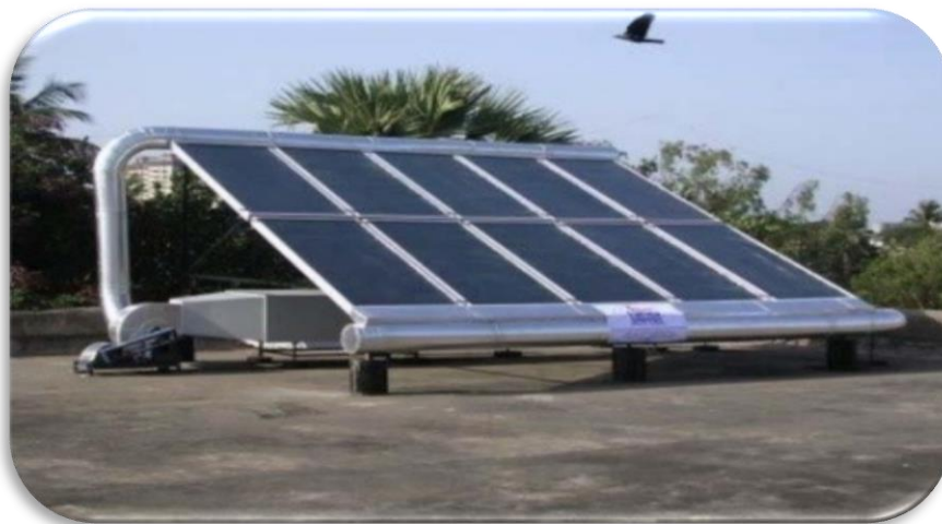
Figure 2. Une pilote de séchage solaire ( Aware and Thorat, 2012 )
