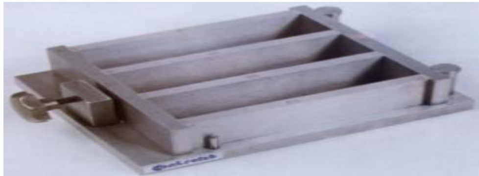
Figure II.2: Le moule utilisé dans la préparation des monolithes
