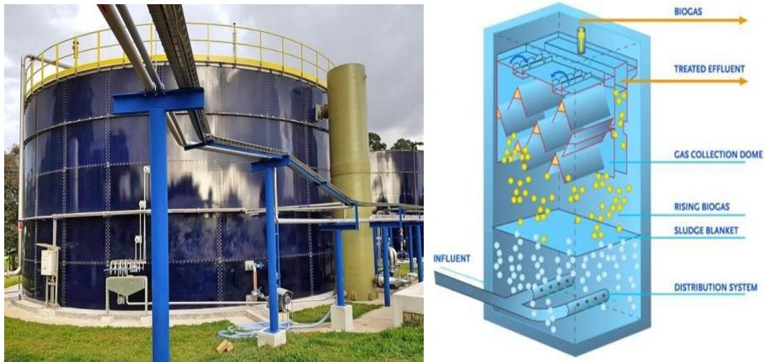
Figure IV. 9: Réacteur UASB (a) Vue d'ensemble, (b) Vue schématique du fonctionnement du réacteur
