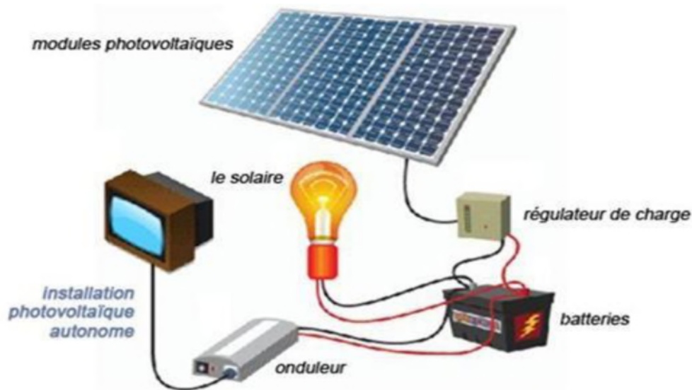
Figure I.11: Schéma d'un système photovoltaïque en mode autonome.
