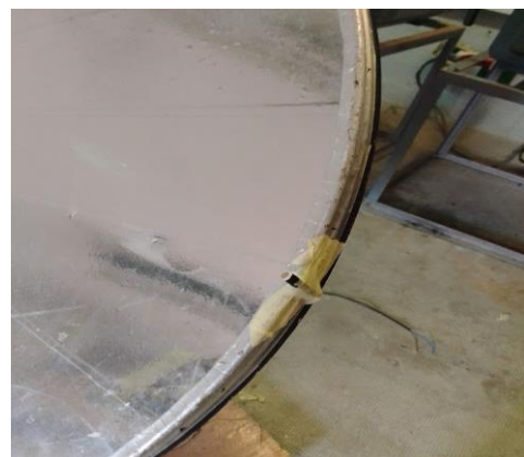
Figure IV-9: Installation des capteurs photorésistances.
