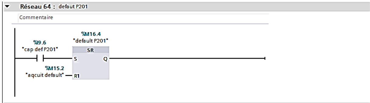
Réseau défaut pompe p201
