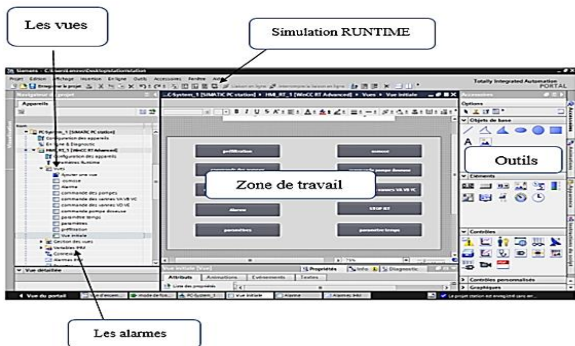
Figure IV.11 : Constitution d'une vue WinCC
