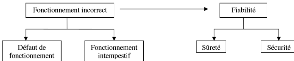
Fig. II. 7 : Fiabilité d'une protection [19]
