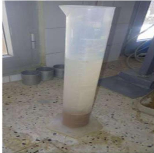
Figure II.8 : Méthode de mesure de la masse volumique absolue.
