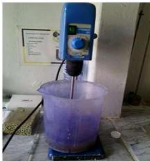
Figure II.13 : Agitateur contenant la solution de bleu de méthylène (GLOBAL CONCEPT /Laboratoire & Engineering à El Bouni/Annaba).
