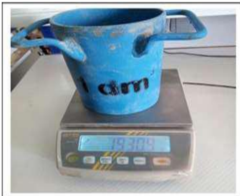
Figure II.6 : Etapes d'essai de la masse volumique apparente.
