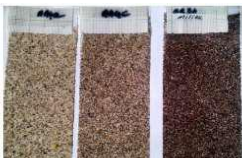
Figure II.16 : Exemple de montage des échantillons de sable sur film adhésif,
