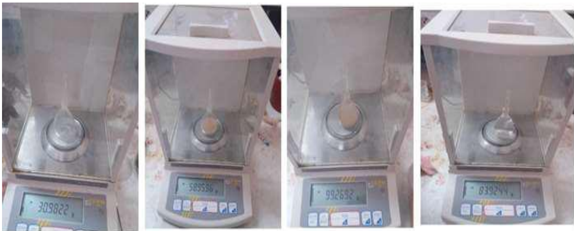
Figure II.9 : les différentes étapes expérimentales pour la détermination du poids volumique sec.
