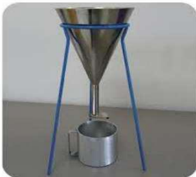
Figure II.7 : Méthode de mesure de la masse volumique apparente.
