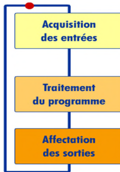
Figure II. 3 Etapes de fonctionnement d'un automate [7]
