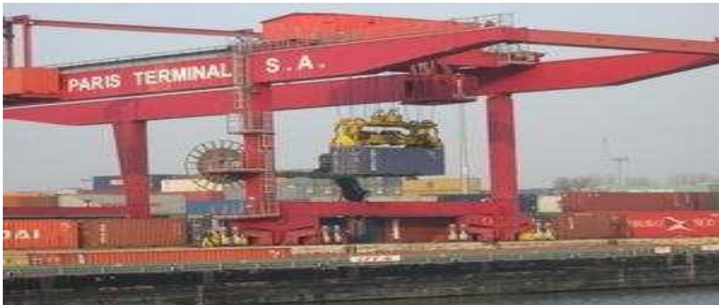
Figure N°3 : Chargement d'une barge par un portique (transport fluvial)
