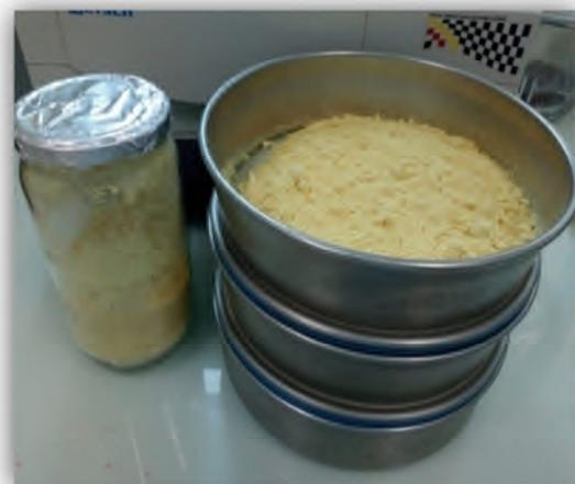
**Figure14** : Photographie du tamiseur (type **RETSCH**)
