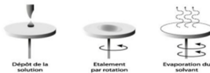
Fig. II.2 : principe de la méthode spin-coating [37].
