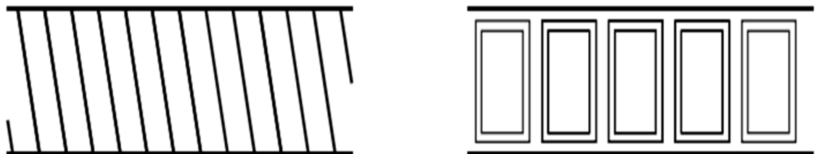
Figure I.7: Schéma développé d'un rotor à cage classique et d'un rotor d'une machine asynchrone à double alimentation type « Brushless » [2]
