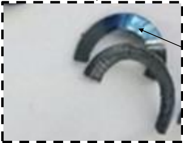
Figure 4.10 zoom sur image d'un copeau de la quatrième plage
