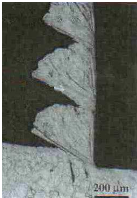
Figure 1.9 Copeau discontinu d'un acier austénitique inoxydable usiné avec un outil carbure ( V_c = 130\text{m/min} , f = 0,1\text{mm/tr} ). [5].
