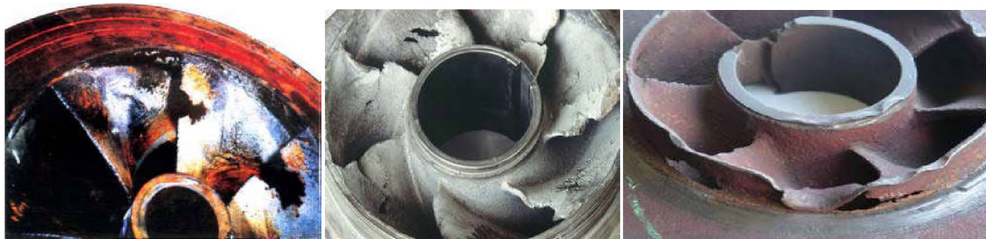
Figure (IV-11) : Érosion par cavitation sur les aubes d'une pompe centrifuge
