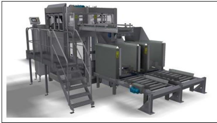
**Figure I.4** Ensacheuse horizontale automatique Scorpion.
