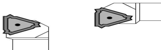
Figure I.28: outils à fileter [9].
