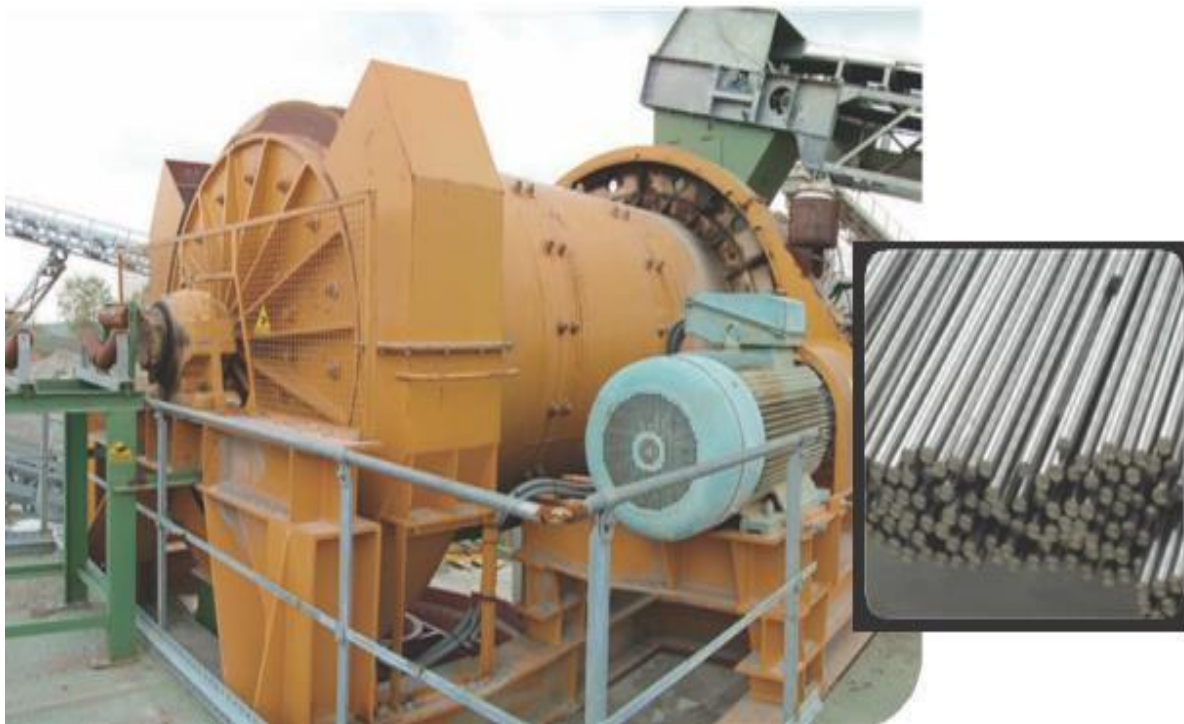
Figure II.5 : Broyeur à barres et barres de broyage de précision
