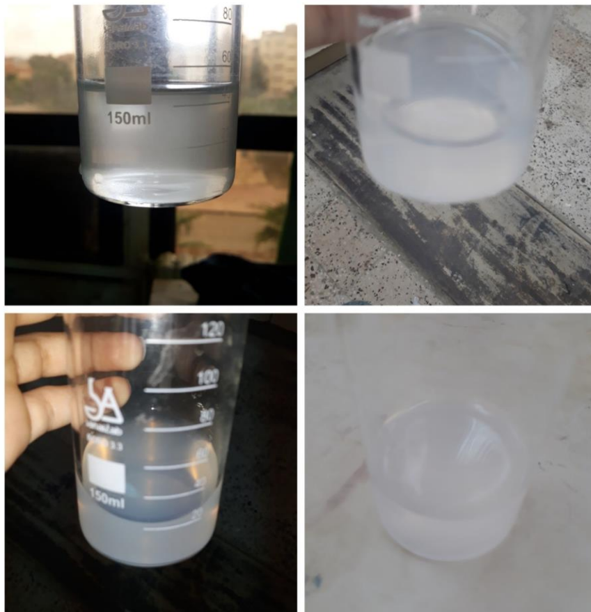
Figure C.29. Changement de couleur de la solution CCP lors de l'ajout de l'inhibiteur chimique.
