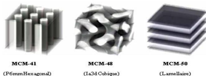
Figure I.16 : Principaux membres des silicates mésoporeux de la famille M41S et symétries correspondantes [2]
