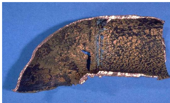
Figure I.7: Corrosion érosion d'un tube en cuivre véhiculant de l'eau [16].
