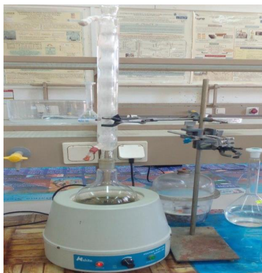
Figure II.7 : Schéma du montage d'extraction à reflux
