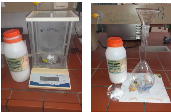
Figure II.5 : Les étapes de la préparation de Tampon PH=5.5
