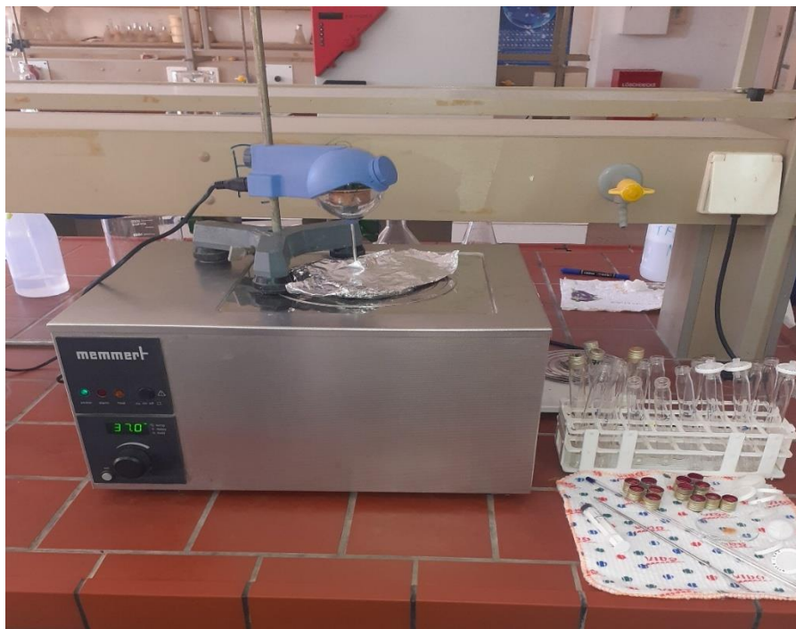
Figure II.13 : Montage de la cinétique de libération de l'amlodipine contenu dans les microparticules de Chitosane /TPP/CPMC.
