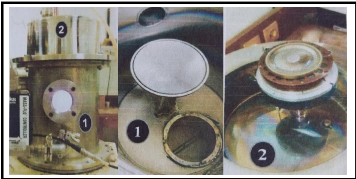
Figure II.3 : Vue de l'extérieur et de l'intérieur de l'enceinte de décharge. [16]
