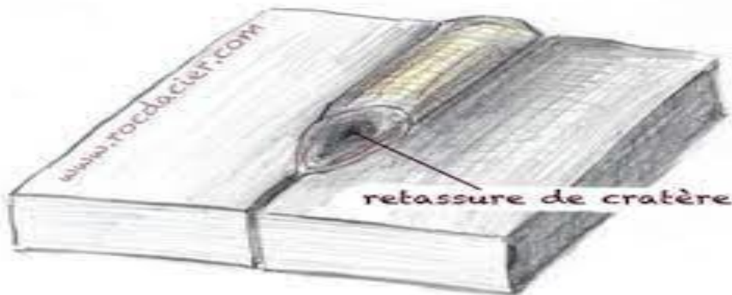
Figure I.12: Fissure de Cratère.
