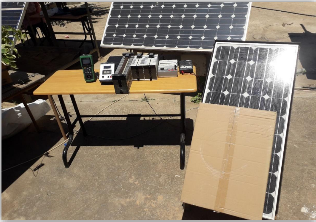
Figure II.11 : Test 2 d'ombrage avec du carton
