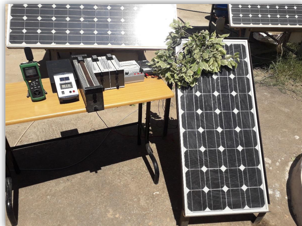
Figure II.8 : Test 1 d'ombrage avec des feuilles d'arbre
