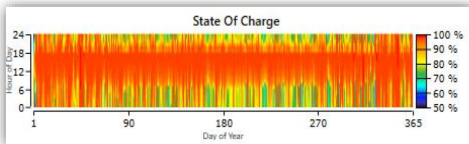
Figure IV.24 : Utilisation de la charge de la batterie à travers une année
