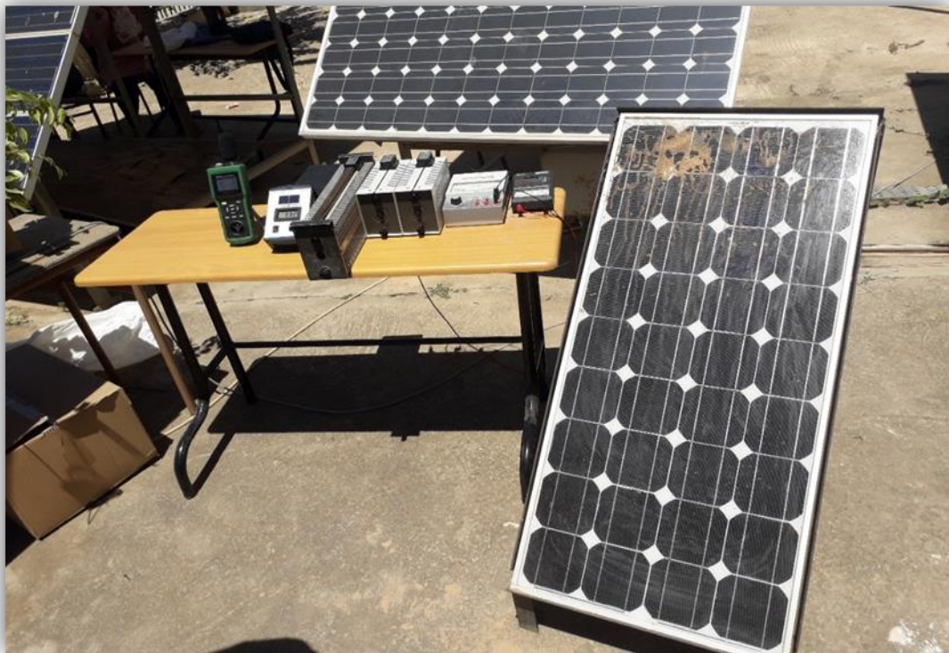
Figure II.12 : Test 1 d'ombrage avec du sable
