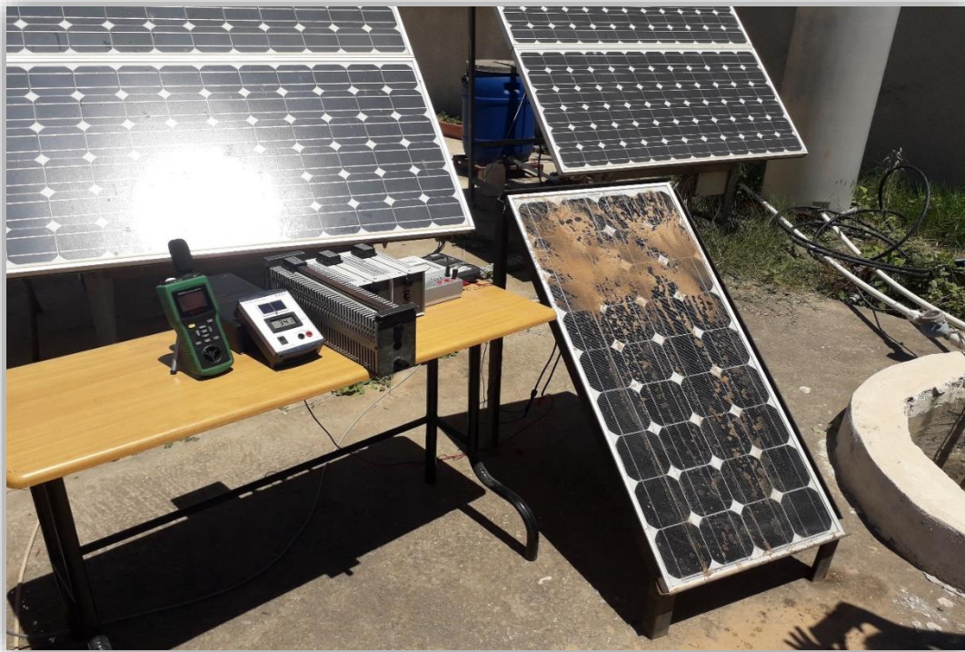
Figure II.13 : Test 2 d'ombrage avec du sable
