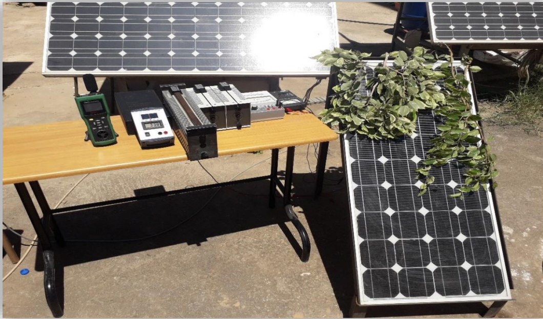
Figure II.9 : Test 2 d'ombrage avec les feuilles d'arbre
