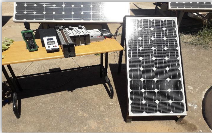
Figure II.6 : Montage de la méthode volt-Ampère-métrique
