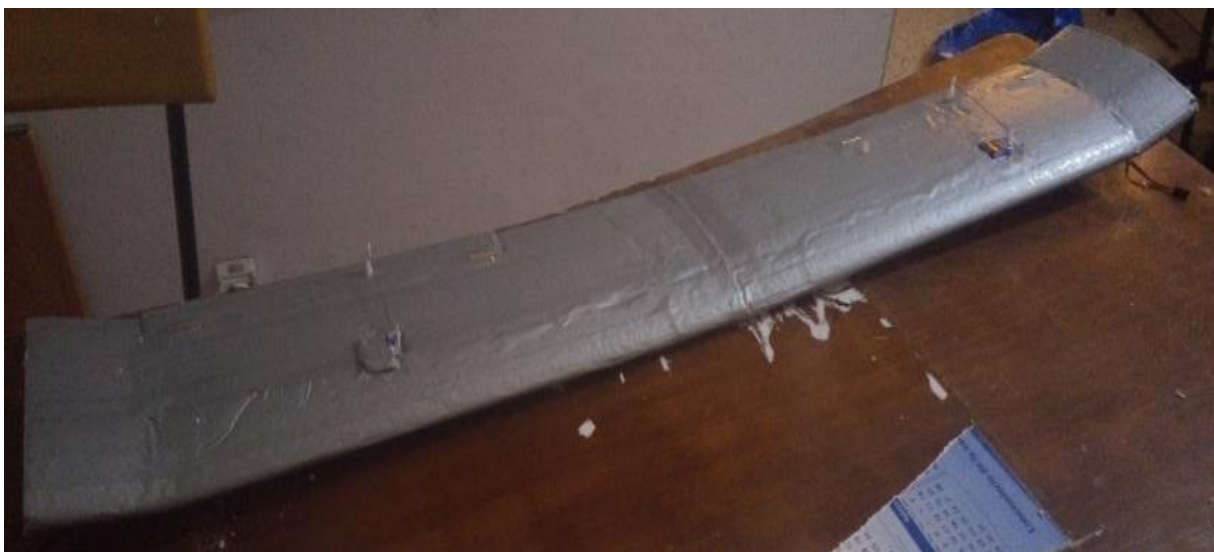
Figure III. 28 : Les deux ailes assemblées avec un dièdre de 2,29^\circ et deux winglets
