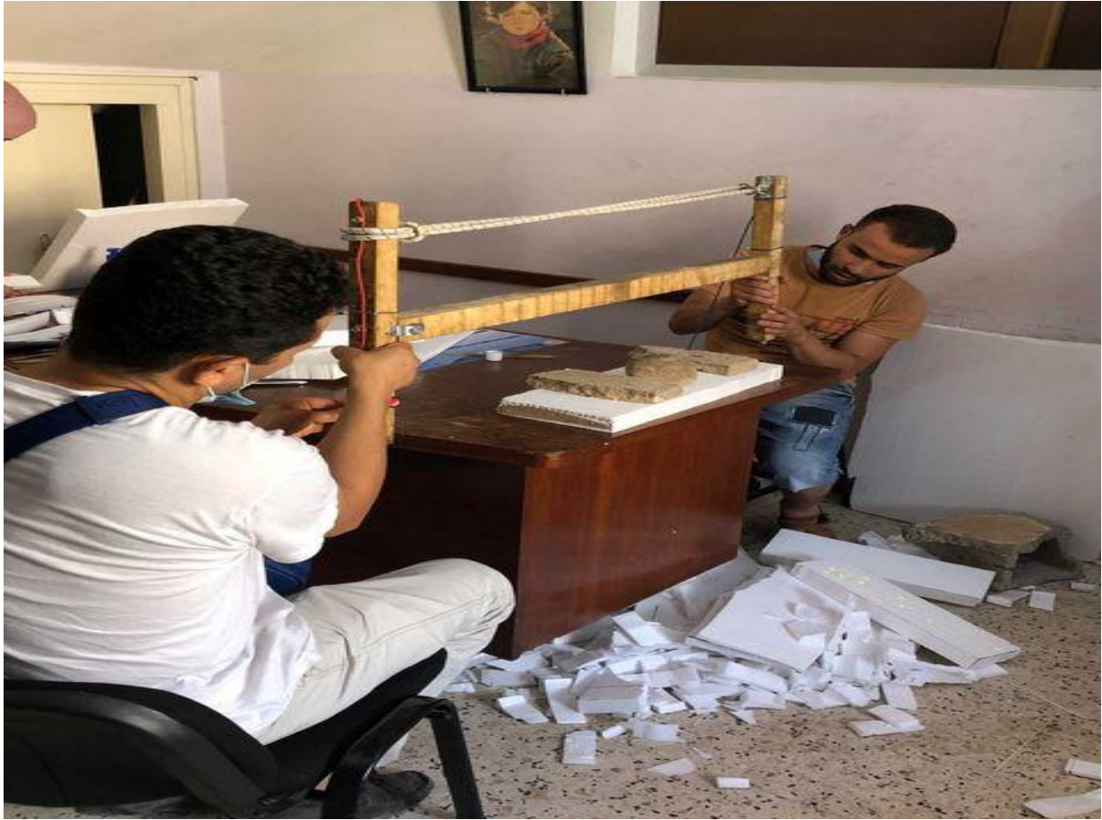
Figure III. 27 : Méthode de découpe des éléments de l'avion RC.
