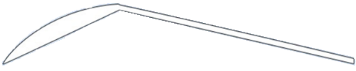
Figure 1.29 : Forme de profil creux de type JEDELSKY
