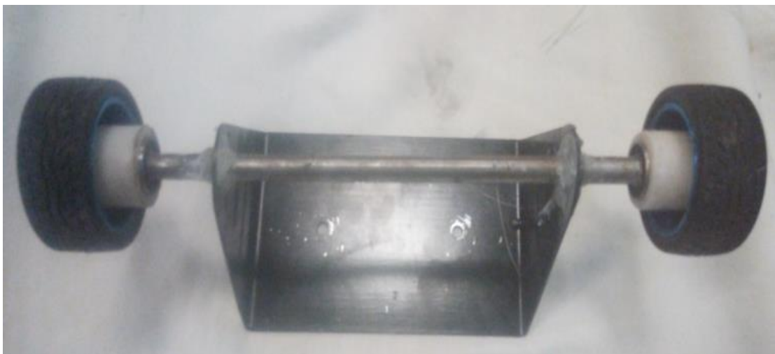
Figure III. 32 : Les deux roues à l'avant avec sa fixation
