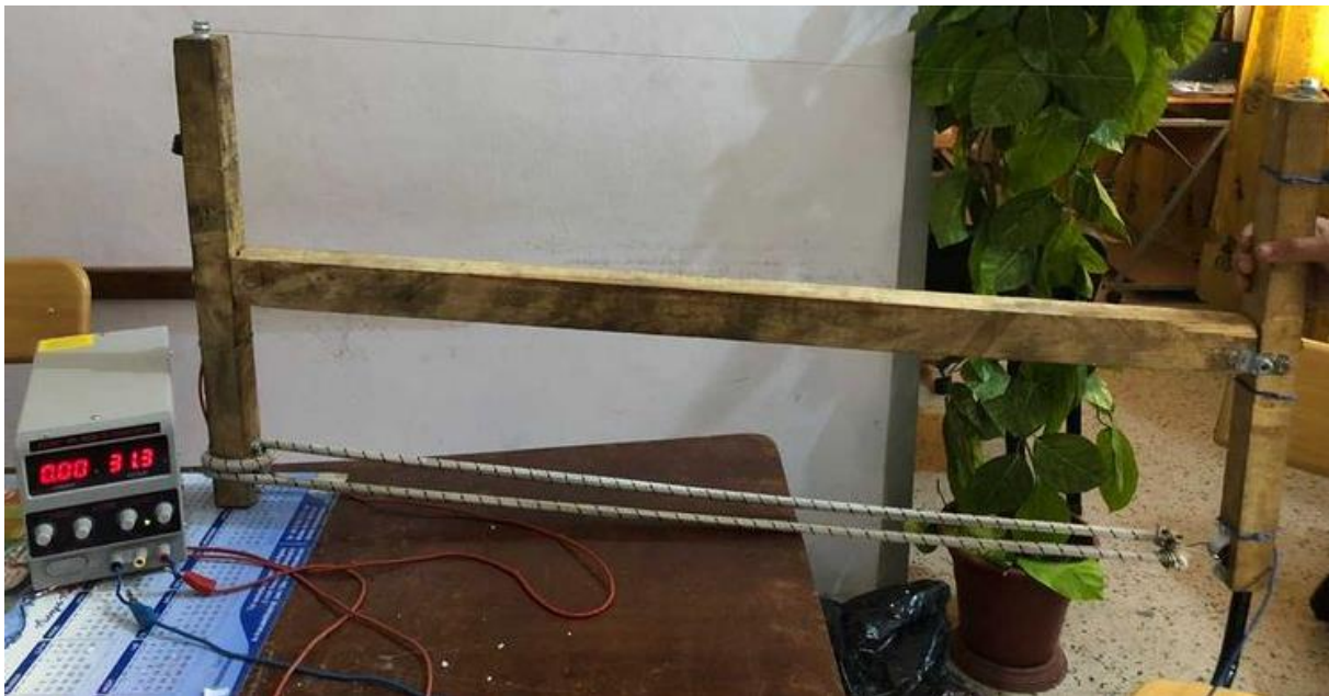
Figure III. 26 : Machine de découpe de polystyrène avec un variateur de tension.
