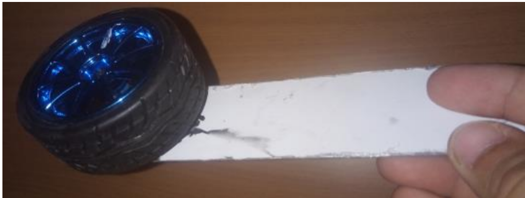
Figure III. 31 : Roue de l'arrière avec sa fixation en aluminium
