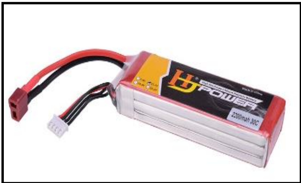
Figure III. 10 : Batterie LiPo 3s, de capacité 2600mAh
