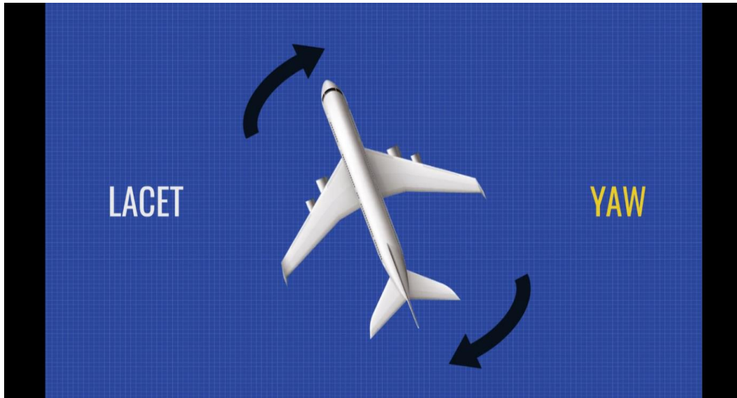
Figure II.13 : Mouvement de l'avion sur l'axe de lacet
