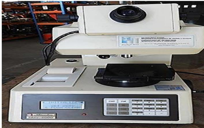
**Fig.II.6 : Le micro duromètre SHIMADZU HMV 2000**
