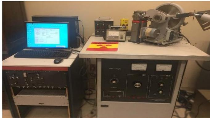
**Fig.II.7 : diffractomètres de type XRG 3000**
