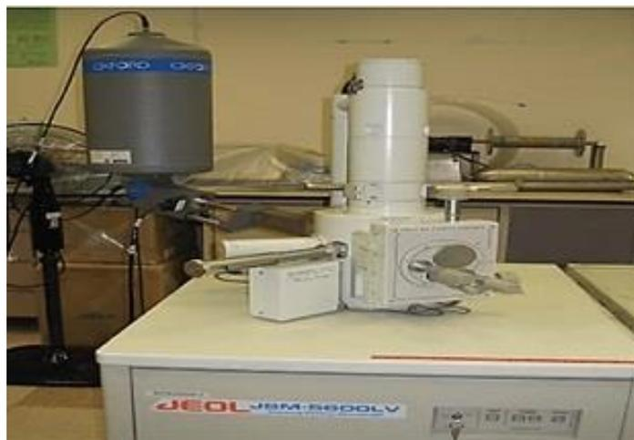
**Fig.II.8 : Microscope électronique à balayage JEOL 5600LV**
