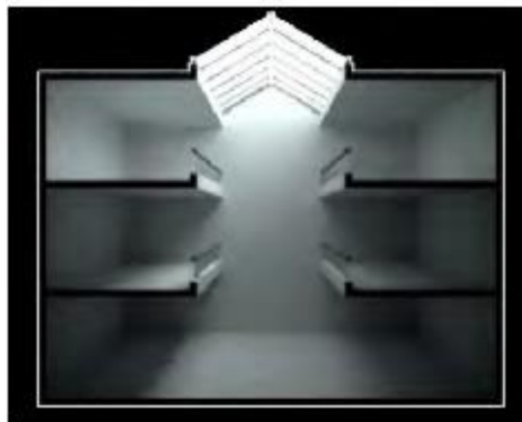
Figure 1. 27: Performances lumineuses du puits de jour.
