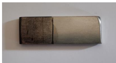
Figure III-3 : Photographie numérique du film \text{PPy@TA6V} synthétisé dans \text{LiClO}_4 .
