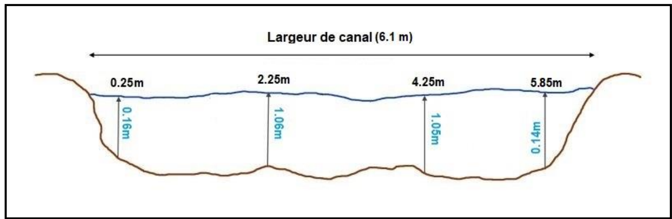
Figure II.9. Schéma de mesure profondeur et largeur a l'aval
