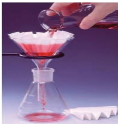
Figure 12. Filtration du minéralisât obtenu à l'issue de l'étape de minéralisation (Cliché, Boudei & Boumezirene)
