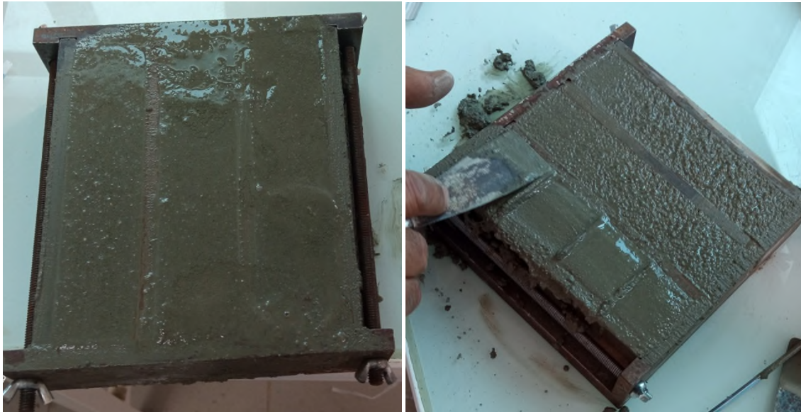
Figure III.12 : préparation des matrices cimentaire (4*4*16)\text{cm}^3 et (4*4)\text{cm}^2
