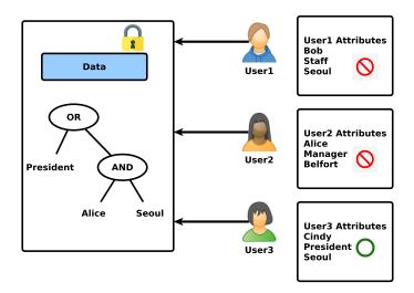
Figure 3.2: CP-ABE-Ciphertext-Policy-Attribute-Based-Encryption[37]
