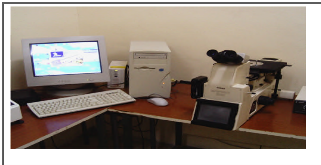
Figure II.9: Ensemble microscope métallographique - système d'acquisition et traitement d'images (labo SGM)
