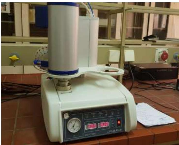
**Figure 11:** appareillage thermogravimétrique.
