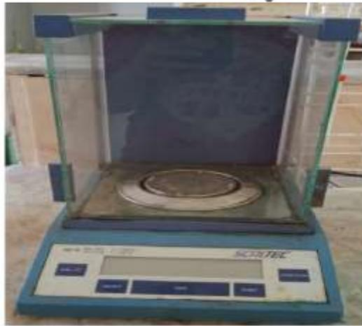
**Figure 13:** Balance électronique.
