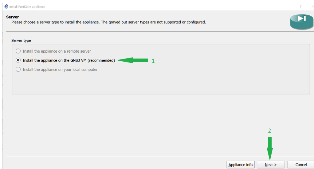
FIGURE 4.7 – Installation de l'appliance sur GNS3
