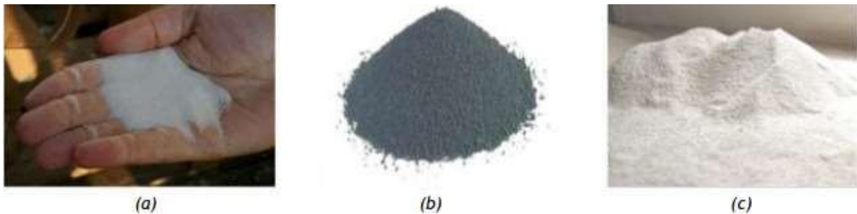
Figure I. 4 : Exemples de charges utilisées dans les CMO : (a) microbilles de verre, (b) noir de carbone, (c) silice.
