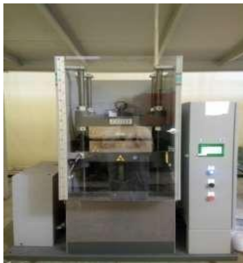
Figure II.16: Photo d'une presse hydraulique utilisée pour la préparation des plaques.
