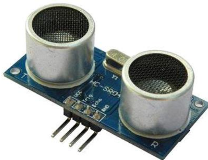
Figure II.3 : capteur ultrason HC-SR04
