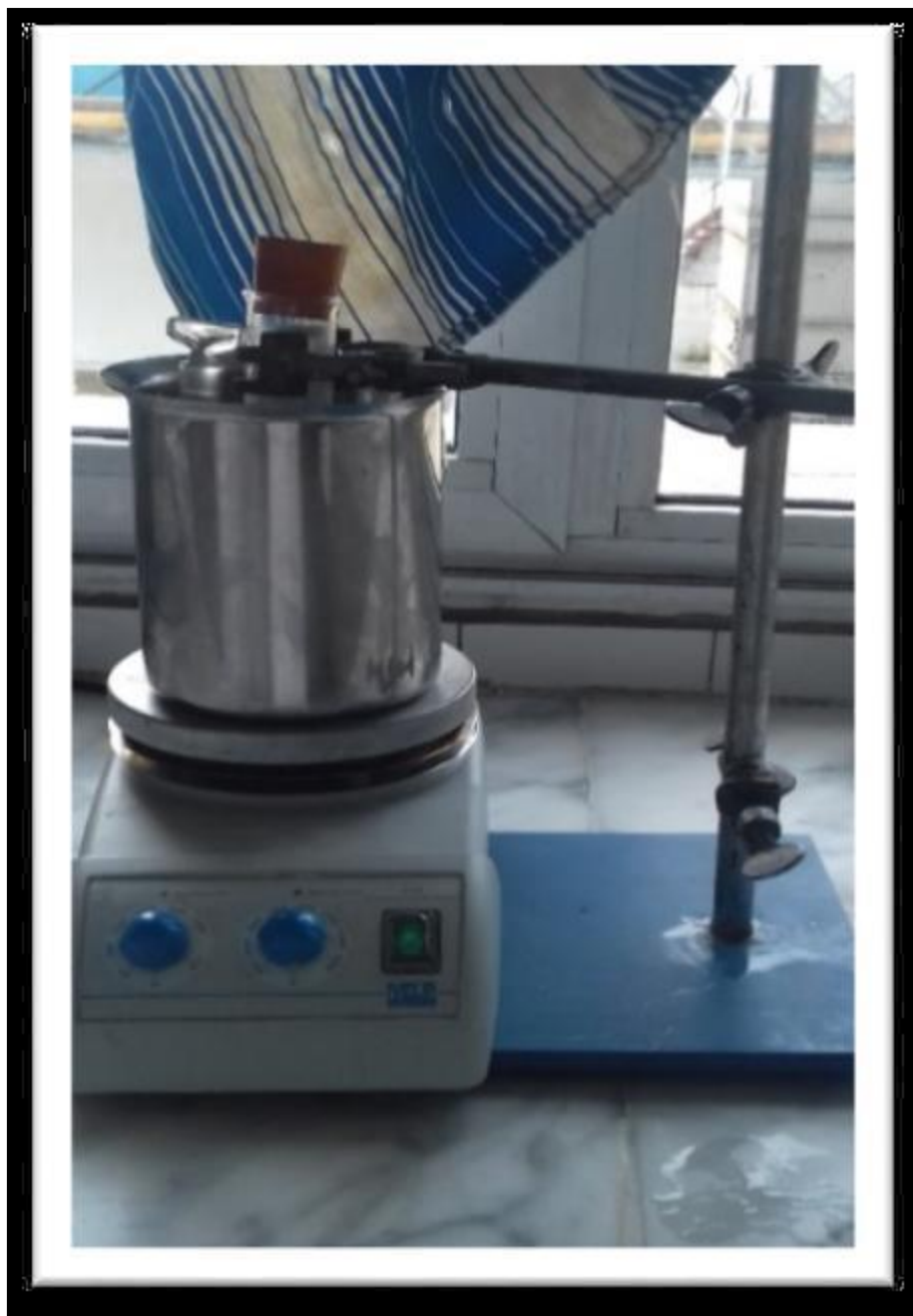
Figure III.3 : Dispositif de dégomme enzymatique de l'huile de soja à l'échelle laboratoire.
