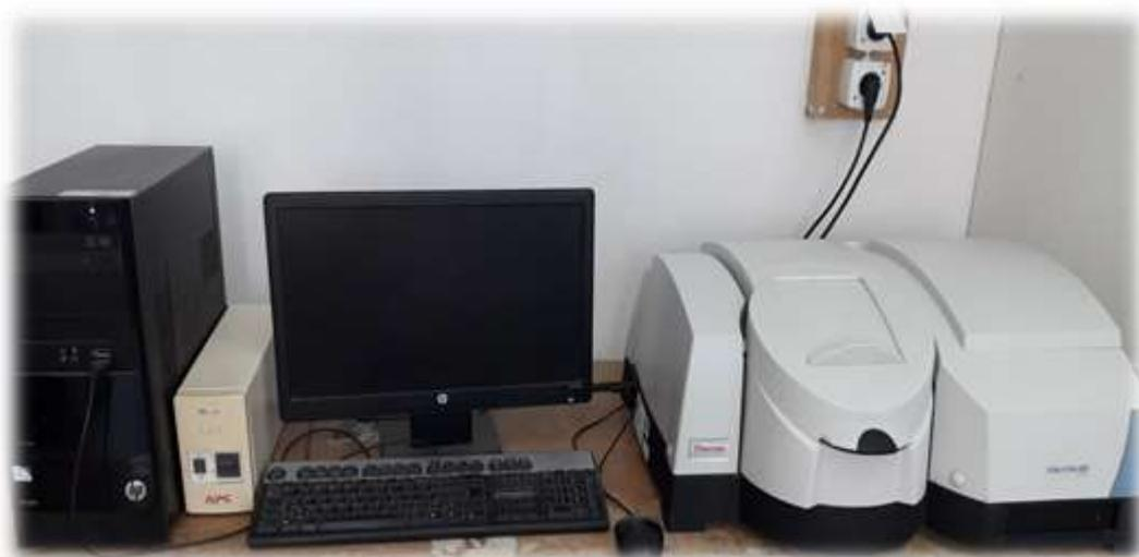
*Figure III.3 : Spectroscopie UV.*
