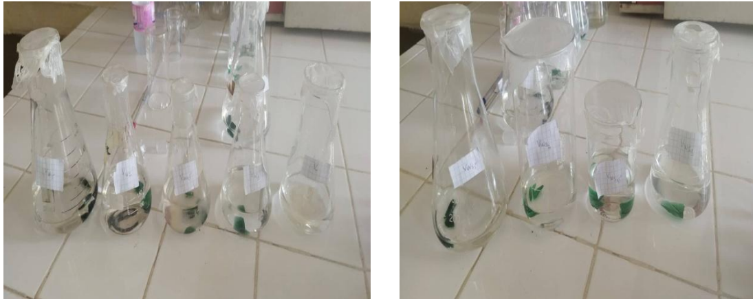
Figure III.1 : Les essais de durabilité des verres dans de l'eau
