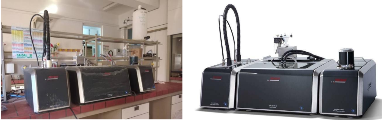
Figure II.4 : Granulomètre laser (ANALYSETTE 22).
