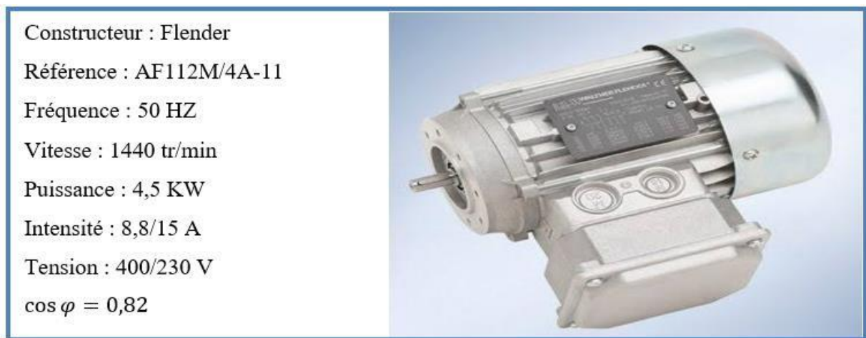
Figure I.6 : Moteur pompe et ses caractéristiques techniques
