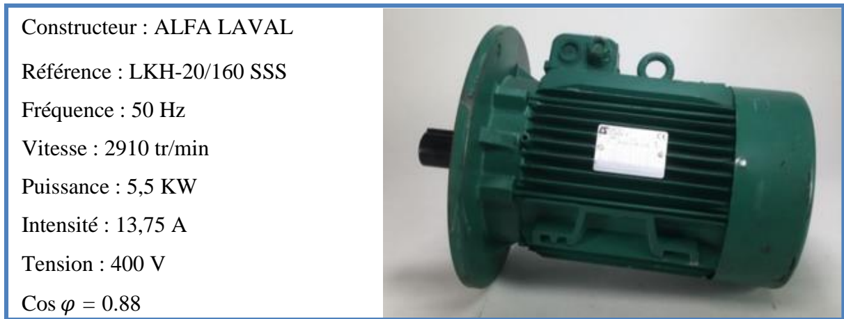
Figure I.6 : Moteur pompe et ses caractéristiques techniques
