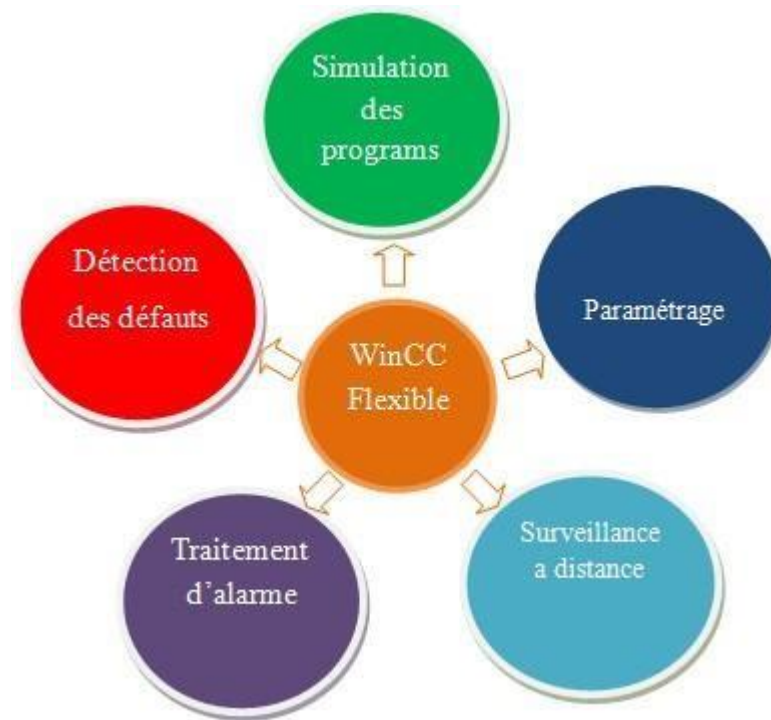
Figure II.11 : Fonctions de logiciel WinCC flexible
